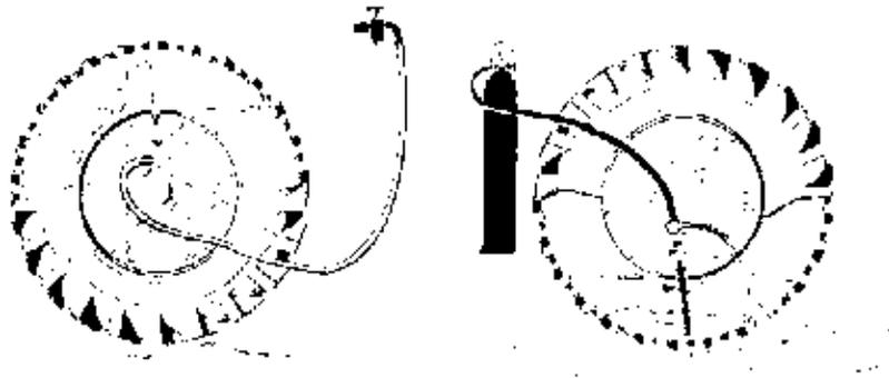
Fig. 101 - Lestage des pneus par eau
