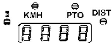
4 led à haute luminosité indiquent également la mesure visualisée sur l'afficheur.
